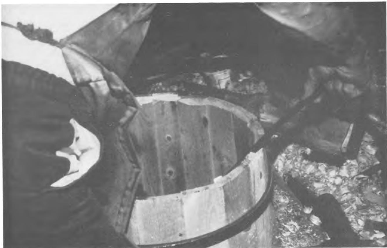
*Det er ikkje mindre enn fem arbeidsoperasjonar som skal til for å laga «logg» og «kryss» i endane på tønna før ein kan sette botn i ho. Første operasjon er å brukha kniven for å smi av dei innerste hjørnene på staven.*
