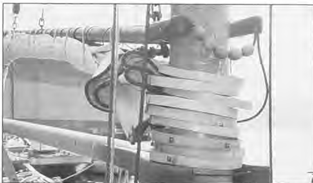
Masteringane, lissingane eller mastrebanda er produsert av Oddbjørn Borge i Tørvikbygd. Han har funne ut at banda blir sterkast dersom ein følgjer den gamle framstillingsmåten, og stiller høge krav til materialane. Banda er laga av spegkløyvd ask.
