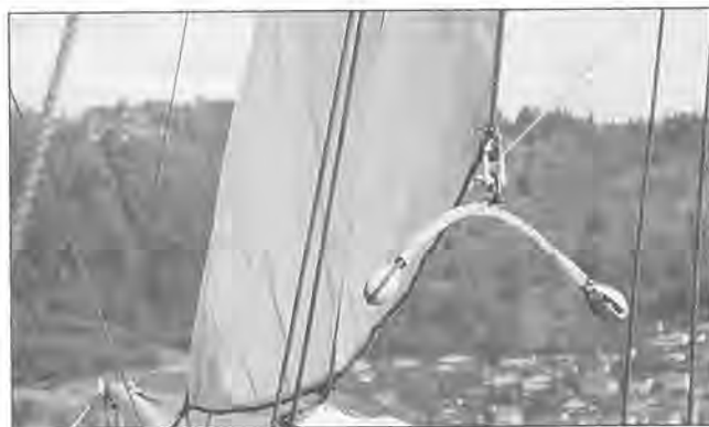
Skinkelen er laga av vaier som først er sett inn med sauetaig, og sidan surra med seglduk og sjømannsgarn.
