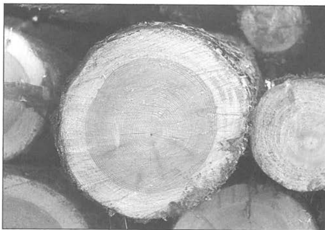
Tverrsnitt av furustokk der me ser margin som ein prikk midt i stokken. Det mørke feltet er adel, og det lyse feltet rundt er geite.
