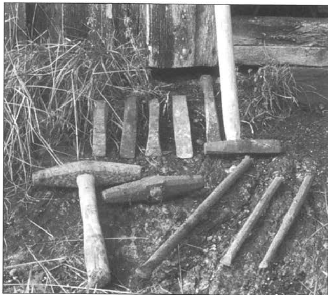
Ei samling av steinverktøyet på Hustveit, med kiler, bor, sett og feisel.
