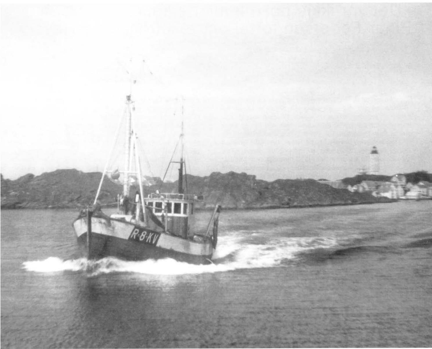
«Midtfjell» på veg ut fra Ydstebøhavn til rekefeltet. Skøyta var på 40 fot og hadde lenge ein Rapp-motor på 56 hestekrefter. Seinare vart den skifta ut med ein GM-motor på 183 hestekrefter. Foto utlånt av Einar Pedersen.
