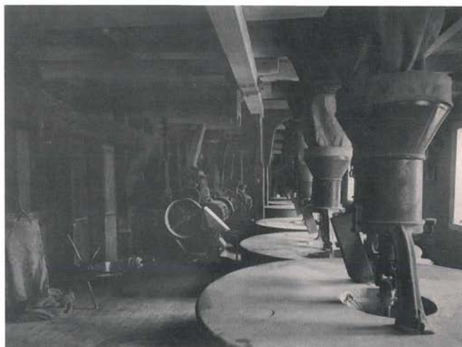
Frå andre etasje i mølla. Kornet kjem ned til kvernsteinane i stryter frå etasjen over.
